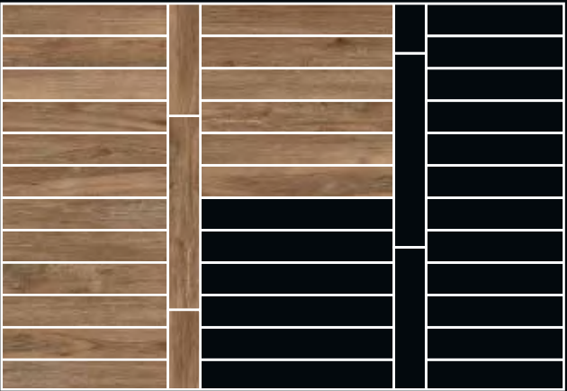
Leiterboden-Verlegung Ladder pattern
